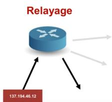
Au sein d'un réseau, le relayage consiste à trouver la bonne sortie, celle qui mènera un paquet au plus proche de sa destination et à trouver au sein du réseau le chemin qui mènera vers cette sortie.
